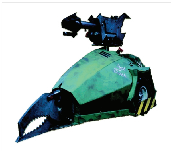
FIGURA 1. Sargent Bash, robot guerrer de 125 kg. Les seves dimensions són 140 \times 90 \times 90 cm i es pot moure fins a 8 mph. Entre les seves armes inclou un bufador de propà.
