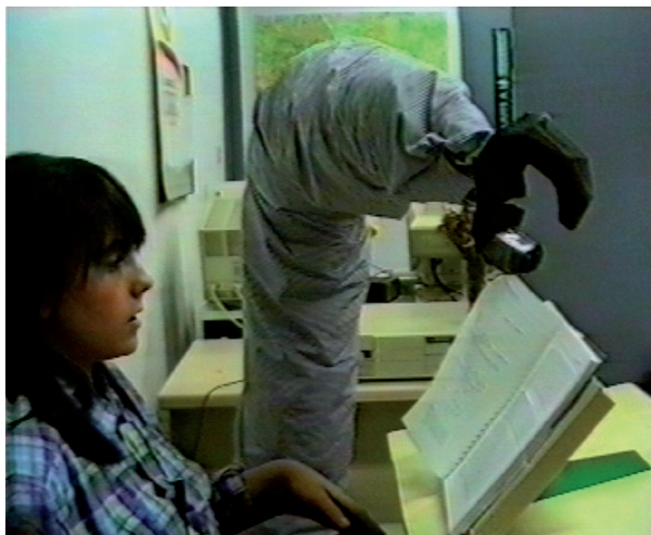
FIGURA 13. Robot TOU, desenvolupat a la UPC basat en una estructura flexible.
