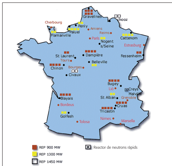
FIGURA 17. Les 58 centrals nuclears franceses han estat construïdes en 20 emplaçaments: hi ha un emplaçament amb sis centrals nuclears i vuit emplaçaments amb quatre centrals nuclears. La potència nuclear instal·lada a França és de 62.850 MWe i representa el 78 % de l'electricitat produïda (Chambru, 2005).
